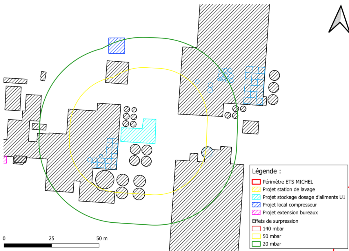
FIGURE 6 : DISTANCES DES EFFETS DE SURPRESSION EN CAS D'EXPLOSION DES SILOS DE LA FUTURE TOUR DE STOCKAGE-DOSAGE DES ALIMENTS
